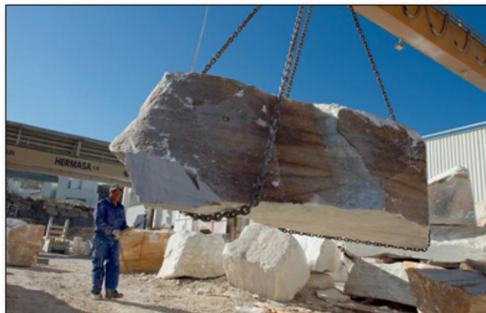
LISTO PARA CORTAR. Un operario traslada el bloque de mármol desde la plataforma del vehículo hasta la máquina cuadradora. De allí pasará a los telares que lo convertirán en láminas.
