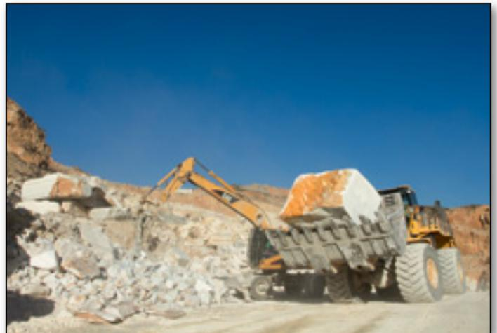
**AL CAMIÓN.** La pala traslada el cubo para depositarlo sobre la plataforma del camión. De allí, rumbo a la fábrica.
