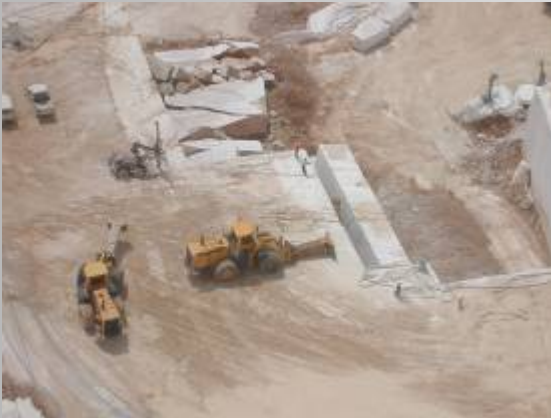
"TORTA " PREPARADA PARA SU DESPRENDIMIENTO EMPUJE CON CATERPILARS SOBRE "CAMA " PREPARADA
